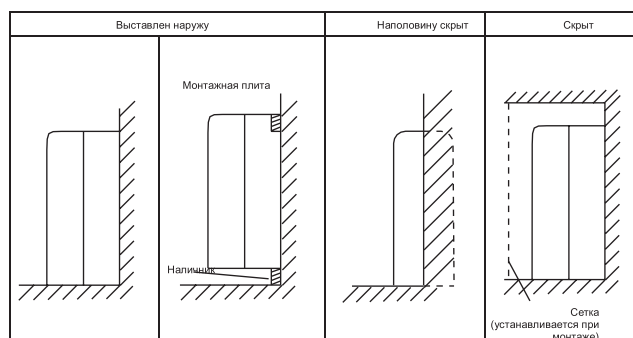
Место крепления монтажной панели.
