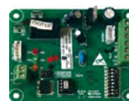
Согласователь работы двух кондиционеров YCJ-A002
